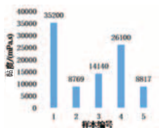
图5 5种市售样品的黏度测量结果
