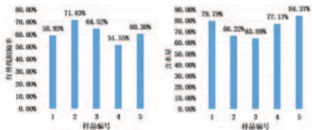
图4 5种市售样品的红外线阻隔率及含水量测量结果
